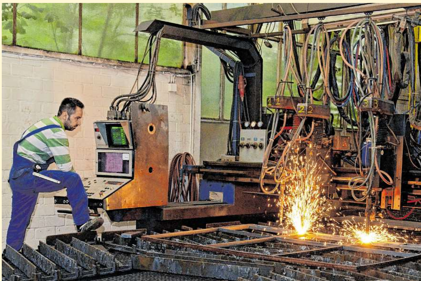
In den Produktionsstätten von Stahlbau Henfling wird mit höchster Präzision und computergesteuerten Maschinen gearbeitet. FOTOS (3): TEICHFISCHER
